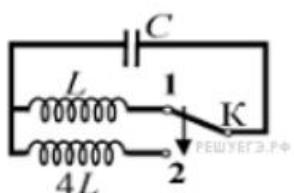
Как изменится период собственных электромагнитных колебаний в контуре (см. рисунок), если ключ  $K$  перевести из положения 1 в положение 2?
